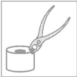
Nach dem Guss Muffeln – an einem geschützten und gekennzeichneten Ort – an der Luft auf Handwärme abkühlen lassen, **nicht in Wasser abschrecken!** Einbettmassen enthalten Quarz. Staub nicht einatmen! Gefahr von Lungenschäden (Silikose, Lungenkrebs). Um Staub beim Ausbetten zu vermeiden, die nach dem Guss völlig ausgekühlte Muffel in Wasser legen, bis sie durchfeuchtet ist.
