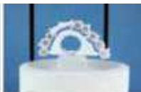
Positionnement correct sur le support de frittage
